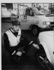
SJEKK MØNSTERDYBEN: Inspektør Jan Svein Aasbo råder alle bilere til å sjekke dyben sin minst to ganger i året. Her er mønsterdyben såvidt over 3 millimeter. Det holder en stund ...
